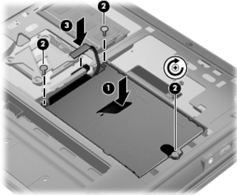
4. 將服務存取門上的定位片 (1) 對準服務存取插槽中的凹口，然後放回存取門。
