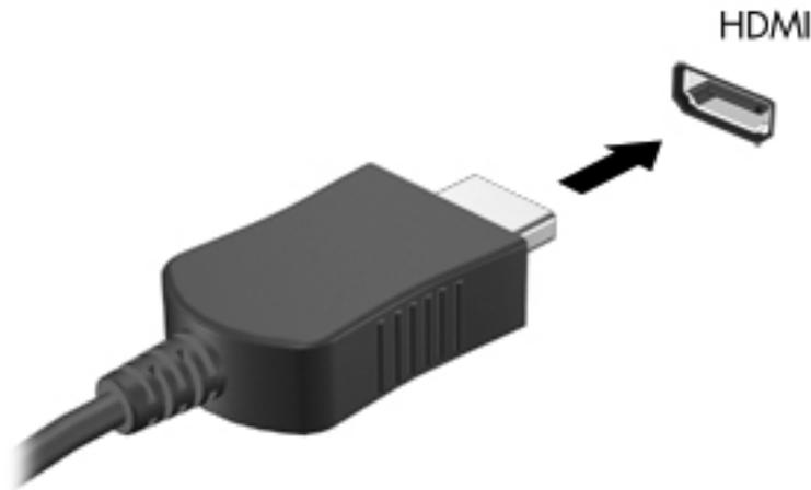
2. 依裝置製造商的指示，將纜線的另一端連接到視訊裝置。
