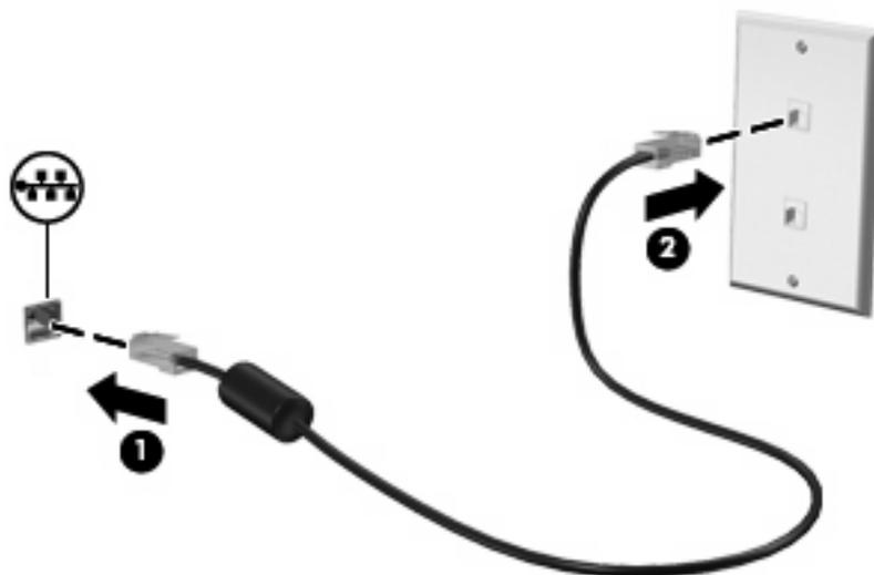
△ **警告!** 為降低觸電、火災，或損壞設備的風險，請勿將數據機或電話線插入 RJ-45（網路）接頭。
