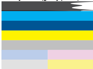
Rysunek 11-2 Kolorowe paski - nieregularne zabrudzenia lub zmniejszona intensywność (górný pasek)
