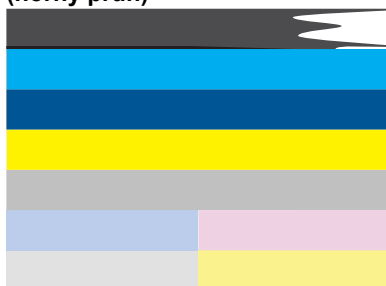
Obrázok 11-2 Farebné pruhy – nepravidelné prúžky alebo vyblednutý pruh (horný pruh)
