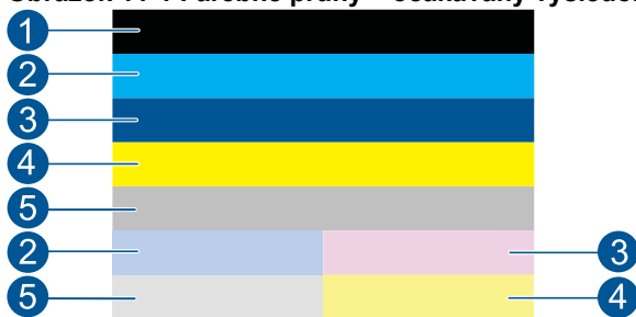
Obrázok 11-1 Farebné pruhy – očakávaný výsledok
