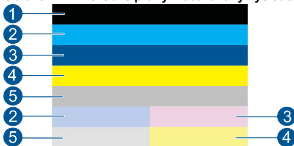
Obrázok 12-1 Farebné pruhy – očakávaný výsledok
