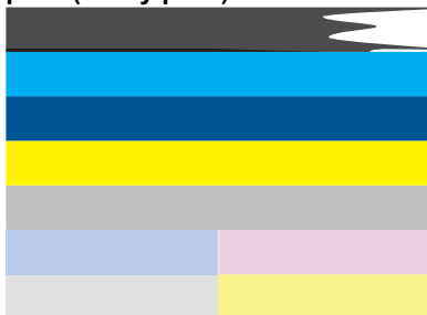
Obrázok 12-2 Farebné pruhy – nepravidelné pružky alebo vyblednutý pruh (horný pruh)
