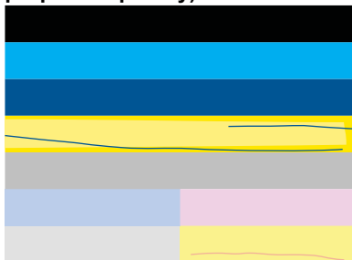
Obrázok 12-3 Farebné pruhy – miešanie farieb (žltý pruh obsahuje purpurové pružky)
