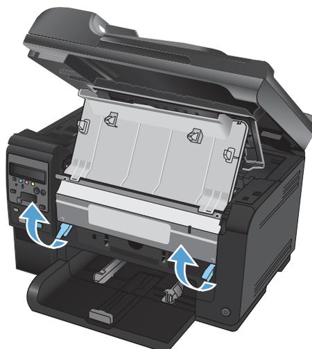
4. Rimuovere il tamburo fotosensibile da sostituire.
