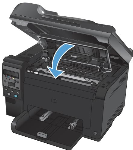
**MERK:** Hvis du får statusvarselsmeldingen **Feil kassett i spor for <farge>** når du skriver ut, fjerner du skriverkassetten fra det angitte sporet og sammenligner fargeetiketten på skriverkassetten med fargeetiketten i sporet for å finne den riktige skriverkassetten for sporet.
