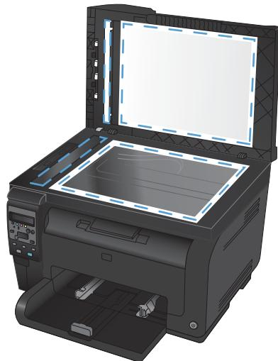
4. Tørk av glasset og den hvite plaststøtten med et pusseskinn eller en cellulosesvamp for å unngå flekker.
