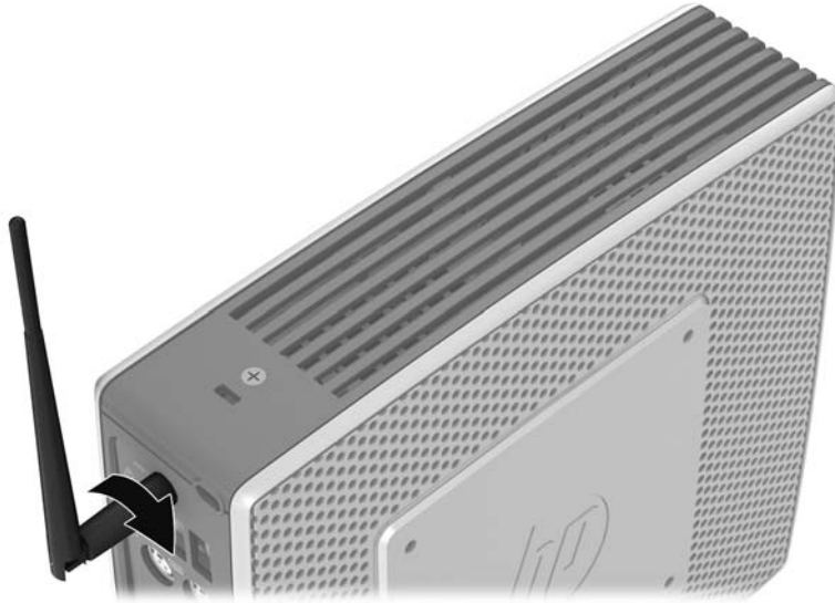
Figure 1-5 Installation de l'antenne
