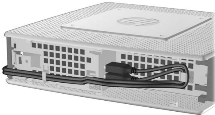
Figura 2-7 Uso do slot seguro para roteamento de cabo
