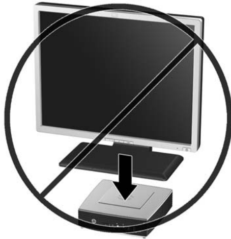
Figura D-5 Não coloque um monitor sobre o thin client
