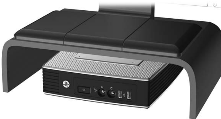
Figura D-3 Embaixo da base do monitor com pelo menos uma polegada de espaço
