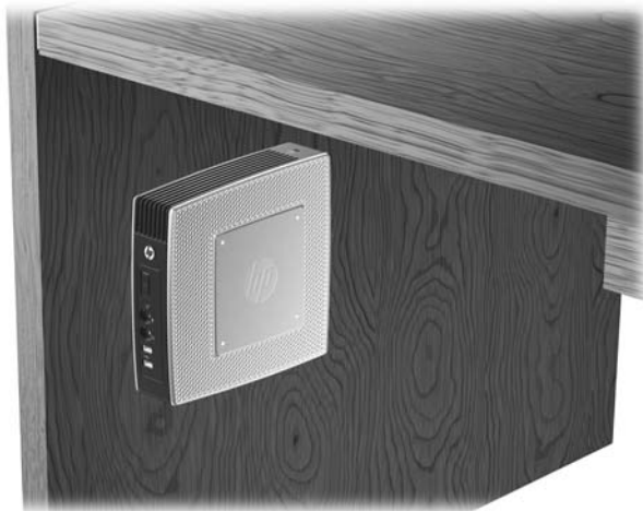
Figura C-8 Thin client montado embaixo da mesa
