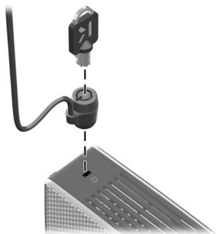
Figura B-1 Fixação do thin client
