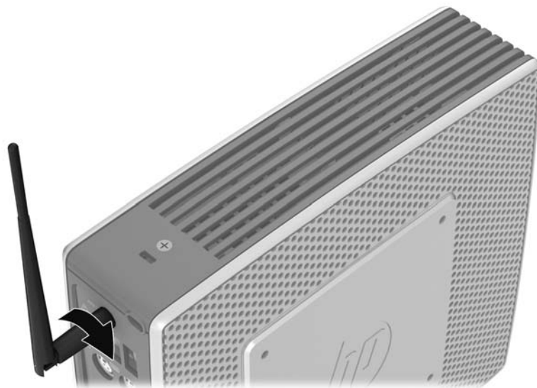
圖示 1-5 安裝天線
