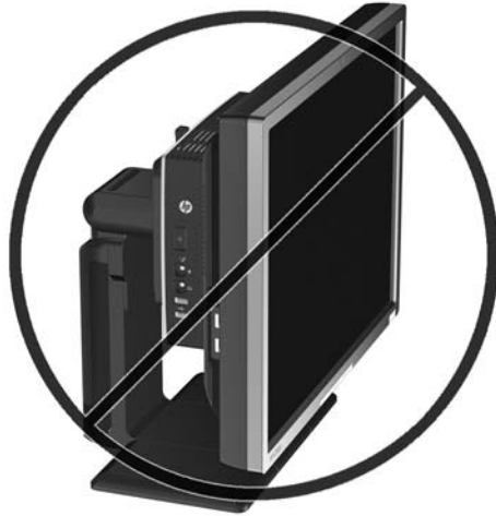
그림 C-9 지원되지 않는 장착 위치 — 받침대와 모니터 사이의 썬 클라이언트
