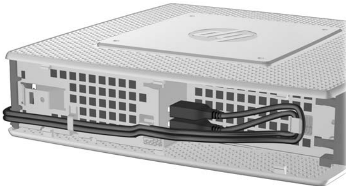
Figura 2-7 Uso de la ranura segura de ruteo de cables
