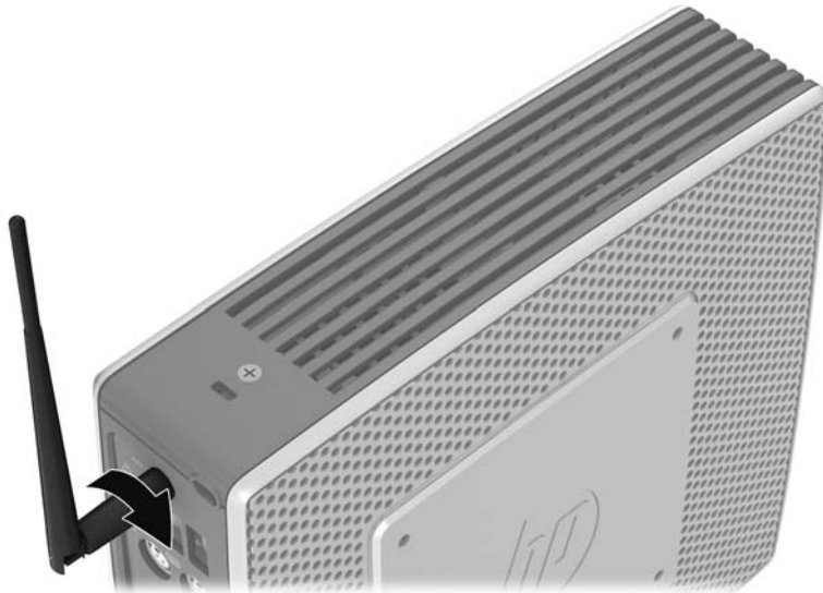
Figura 1-5 Instalación de la antena
