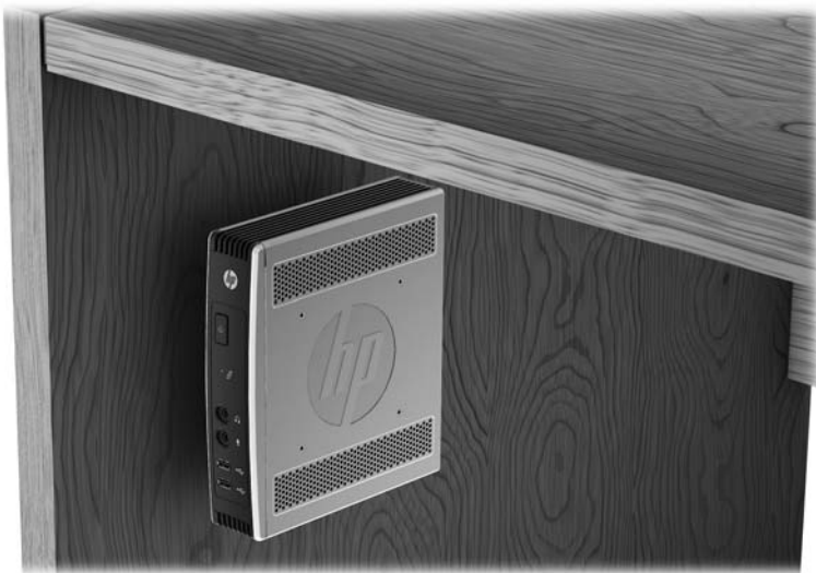
图 C-8 安装在桌子下面的瘦客户机
