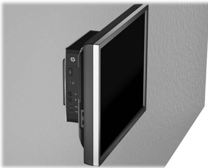
图 C-6 安装在监视器底座背面的瘦客户机
