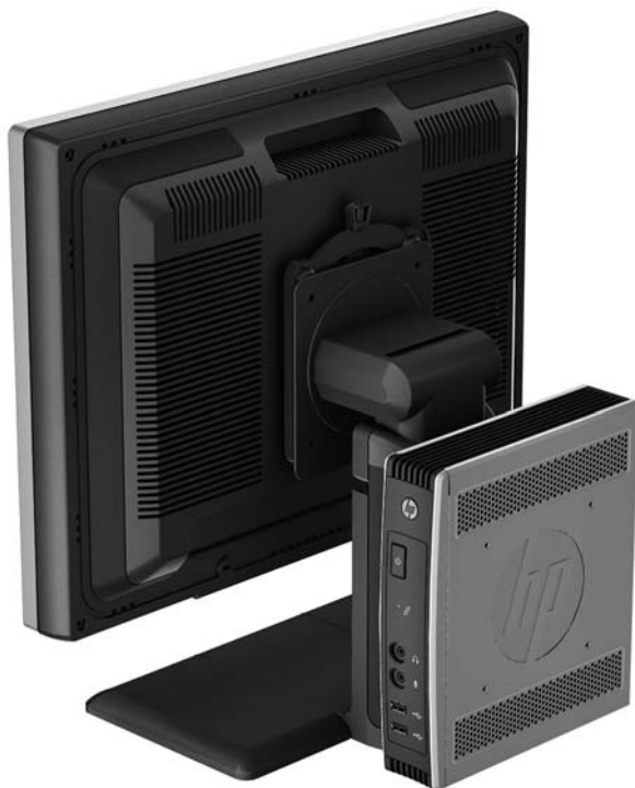
图 C-6 安装在监视器底座背面的瘦客户机
