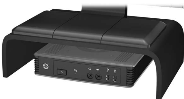
图 D-3 在显示器底座下方并至少保留一英寸的空隙
