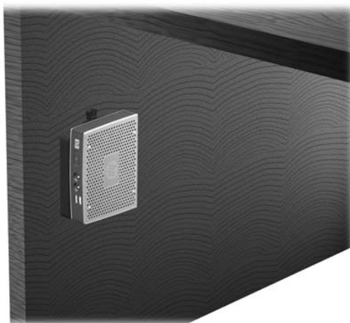
Afbeelding C-8 Thin client gemonteerd onder bureau
