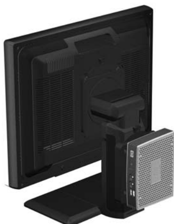
Afbeelding C-7 Thin client gemonteerd aan wand
