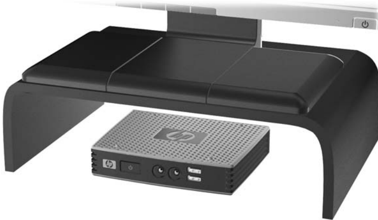
Afbeelding D-2 Onder monitorstandaard met ten minste 2,5 cm tussenruimte
