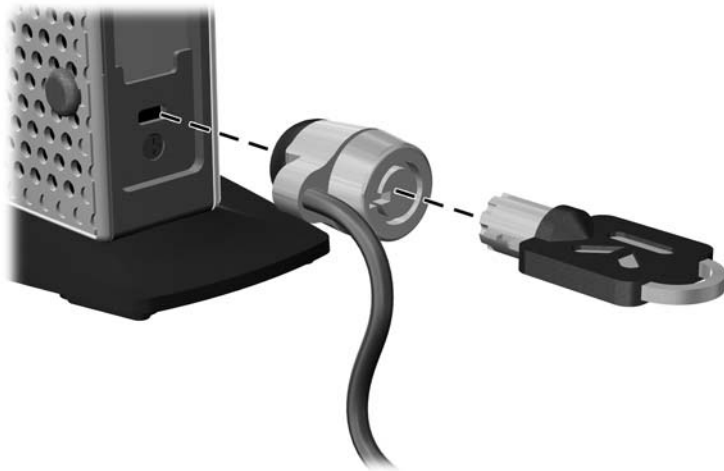
Afbeelding B-1 Thin client beveiligen
