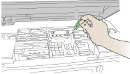
5. Heben Sie den Druckkopf nach oben aus dem Gerät heraus.
