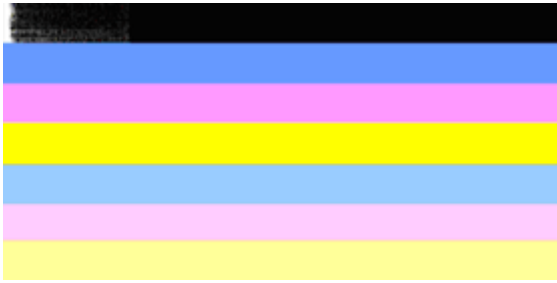
Primjer loših traka boja | Gornja crna traka je neravna na jednom kraju.
