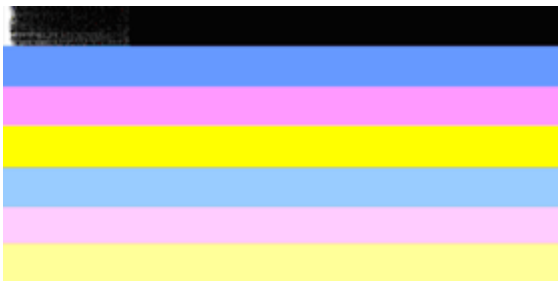
Primer slabih barvnih pasov Zgornji črni pas je na enem koncu obrabljen.
