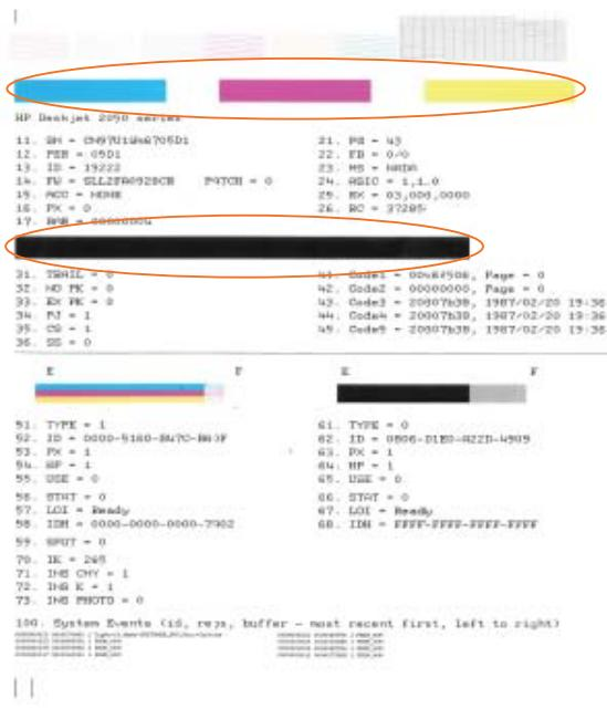
6. Bersihkan kartrid cetak secara otomatis, jika halaman diagnostik menunjukkan garis-garis belang atau ada bagian yang hilang dari kotak hitam dan kotak warna.
