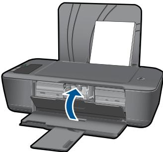
**Catatan** Printer HP akan memerintahkan Anda untuk menyelaraskan kartrid ketika Anda mencetak dokumen setelah kartrid baru terpasang. Ikuti petunjuk pada layar untuk menyelesaikan penyelarasan kartrid. Menyelaraskan kartrid akan memastikan hasil cetak bermutu tinggi.
