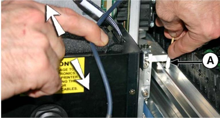
5. Reinigen Sie die oberen schräg stehenden Räder, indem Sie ein mit Isopropanol befeuchtetes Wattestäbchen in die Öffnung oberhalb der Räder einführen (A) und den Schlitten vor und zurück bewegen.
