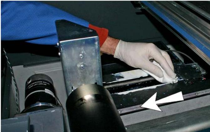
5. Reinigen Sie beide Wischerschienen auf beiden Seiten des Wischerschlittens mit einem fusselfreien Tuch.
