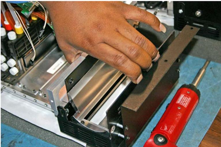
Ziehen Sie die vier Schrauben, die Sie im vorigen Schritt gelöst haben, wieder fest, wenn das Lampengehäuse im Lampensockel eingebaut ist.
