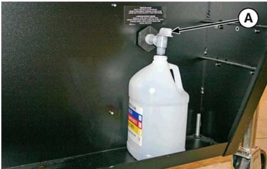
5. Nachdem Sie die Tintenreste abgelassen haben, drehen Sie den Ablaufhahn in die geschlossene Stellung.
