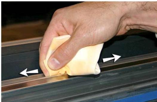
6. Reinigen Sie den unteren Schlittenradstreifen mit einem fusselfreien Tuch und Druckkopfreinigungsmittel von einem Ende zum anderen (bewegen Sie den Schlitten, um die Schiene in der ganzen Länge zu reinigen.)
