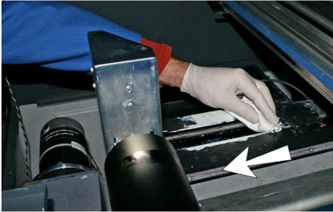
Figura 9-18 Limpieza de la parte superior de la estación de servicio
