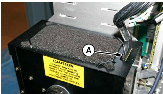
Figura 9-1 Desconecte el cable auxiliar del extremo del usuario
