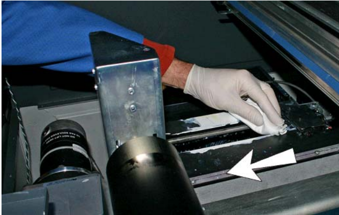
Figure 9-18 Nettoyage de la partie supérieure du poste de service
