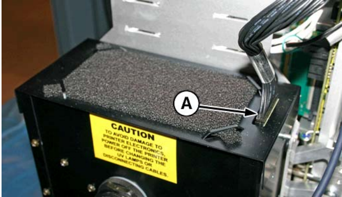
Gambar 9-1 Melepaskan sambungan kabel tambahan sisi pengguna
