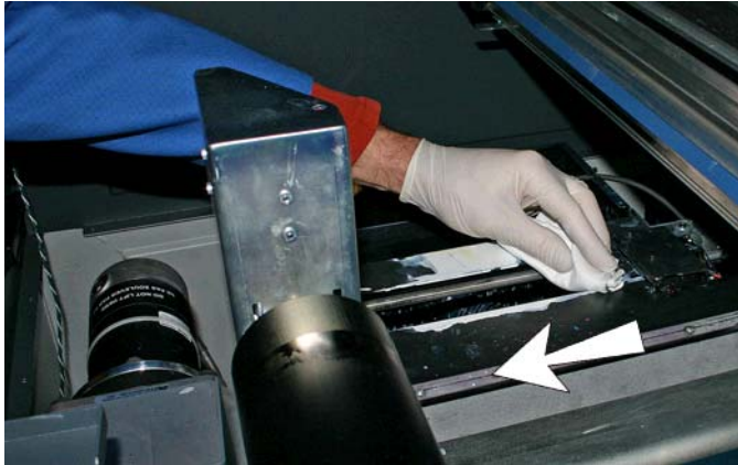
Figura 9-18 Pulizia della parte superiore della service station
