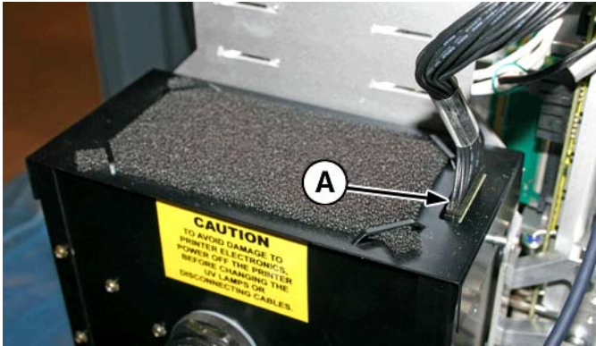
Figura 9-1 Scollegamento del cavo ausiliario lato utente
