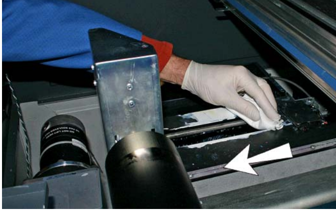
Şekil 9-18 Servis istasyonunun üst kısmını temizleme
