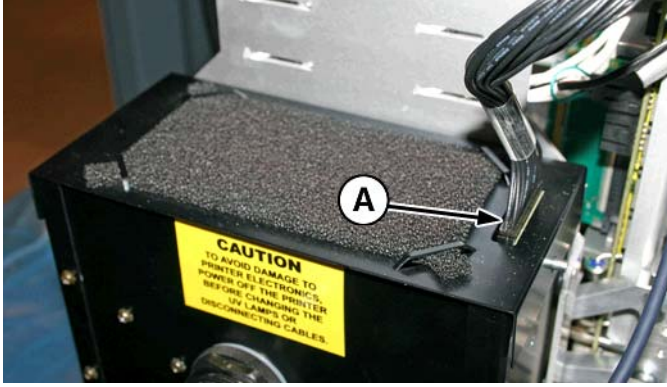
Şekil 9-1 Kullanıcı tarafındaki yedek kabloyu çıkarma
