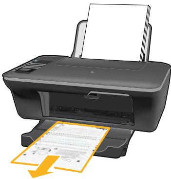
Hızalama sayfasının yazdırılması için 30 saniye bekleyin.
