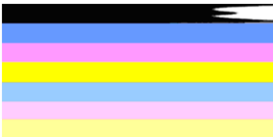
Příklad nesprávných barevných čar Horní čára je nerovnoměrně vyplněna nebo vybledlá.
