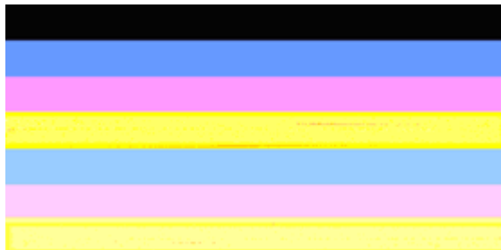
פסים אינם אחידים בדוח איכות הדפסה | בתוך הפסים מופיעים חלקים בהירים יותר או כהים יותר.
