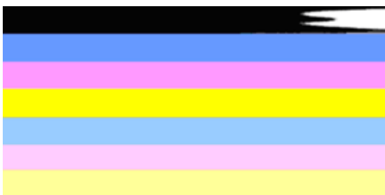
Esempio di Barre di colore errate La barra superiore presenta striature irregolari o sbiadite.
