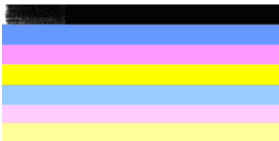
Esempio di Barre di colore errate La barra superiore nera è imperfetta su un'estremità.
