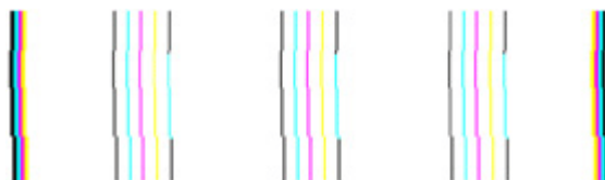
Примеры некачественного выравнивания | Линии имеют зубчатые края, выполните выравнивание принтера. Если это не помогло, обратитесь в HP.
