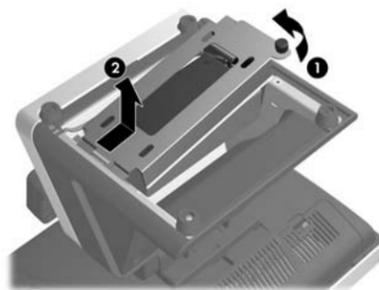
7. Soulevez le bloc d'alimentation et ses câbles pour le retirer de la base de l'appareil.
