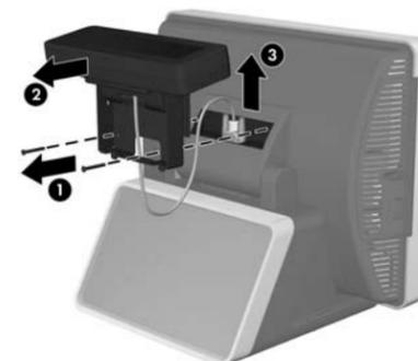
12. Placez de nouveau l'appareil face vers le bas sur un chiffon sec et propre ou sur un coussinet protecteur et retirez la vis du cache de la charnière.
