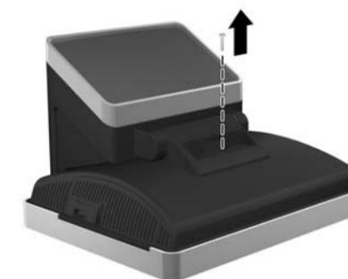
13. Pendant que l'appareil repose face vers le bas, inclinez la base à fond vers l'avant ❶. Retirez le jeu de vis qui maintiennent le support de charnière ❷.
