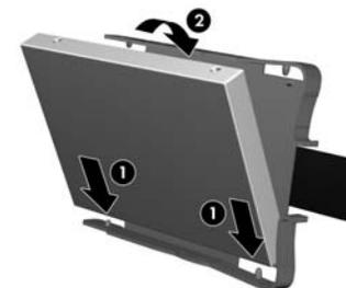
3. Faites glisser fermement le disque dans la baie en insérant d'abord l'extrémité du disque qui comporte le connecteur.
