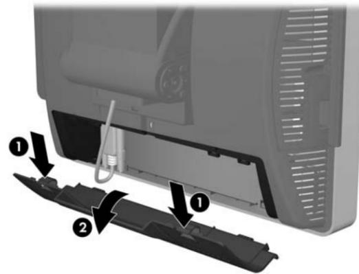
3. Bevor Sie das LCD-Display montieren, müssen Sie die Vakuumfluoreszenzanzeige (VFD-Display) von der Rückseite des ap5000-Geräts demontieren.
