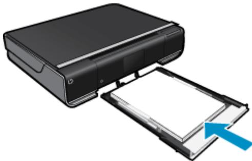
Inserire la risma di carta al centro del vassoio di alimentazione, in modo che il lato corto venga inserito per primo e che il lato di stampa sia rivolto verso il basso. Spingere in avanti la risma sul vassoio, fino a che si blocca.
