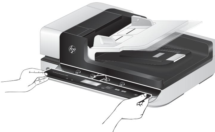
8. Schieben Sie das Bedienfeld vorsichtig gegen die Blende. (Achten Sie darauf, dass das gesamte Bedienfeld korrekt ausgerichtet ist.) Drehen Sie das Bedienfeld nach unten, und drücken Sie es dann nach unten, bis es sicher sitzt.
