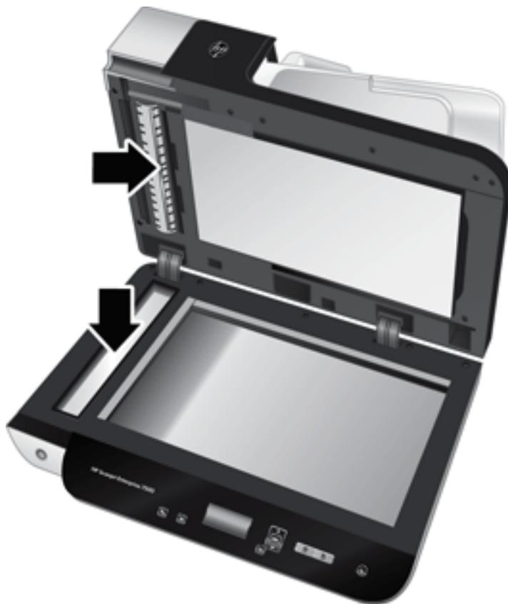
**⚠ ACHTUNG:** Reinigen Sie das Scannerglas und den Scanstreifen ausschließlich mit Glasreiniger. Verwenden Sie keine Reiniger, die Scheuermittel, Azeton, Benzin oder Kohlenstofftetrachlorid enthalten, da diese Substanzen das Scannerglas beschädigen können. Isopropylalkohol ist ebenfalls zu vermeiden, da er Streifen auf dem Glas hinterlassen kann.
