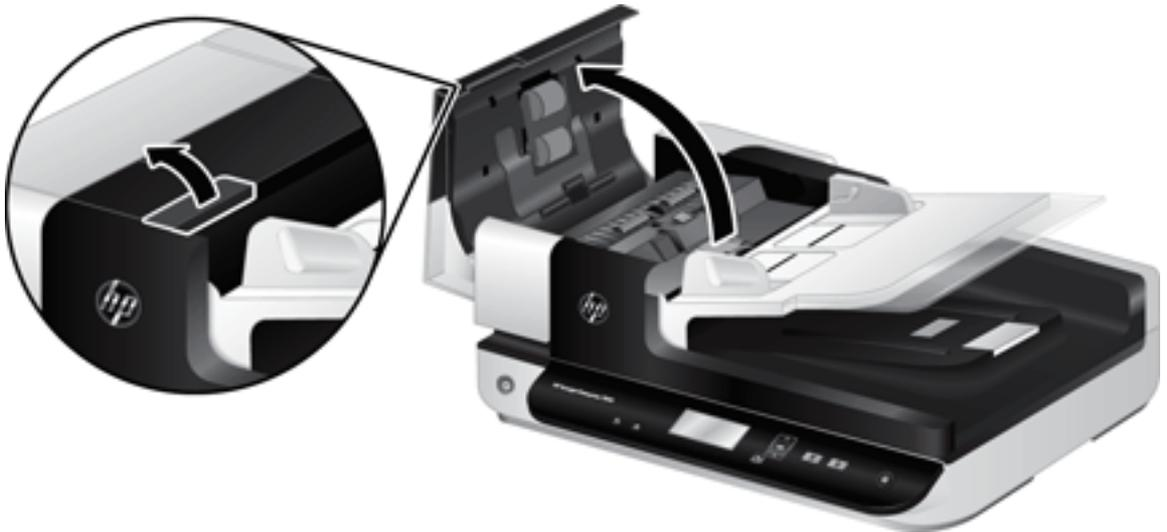
3. Drücken Sie die Verriegelung des Trennstegs nach vorne (zur Rückseite des ADF), um den Trennsteg zu lösen.
