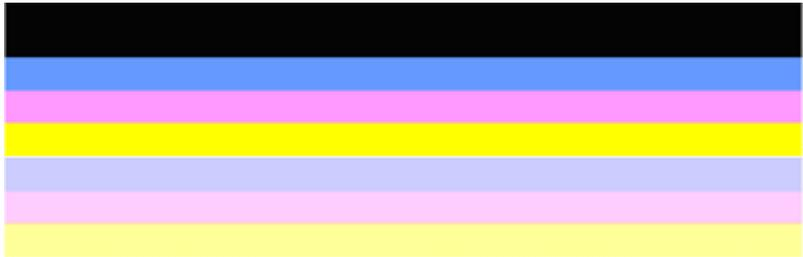
Beispiel für Farbbalken bei hoher Druckqualität: Alle Balken sind gefüllt, verfügen über gestochen scharfe Kanten und weisen über die gesamte Seite eine einheitliche Farbe auf. Der Drucker funktioniert korrekt.
