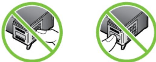
**Hinweis** Gehen Sie mit den Tintenpatronen sorgsam um. Wenn Sie die Tintenpatronen fallen lassen oder anderweitig beschädigen, können vorübergehend Druckprobleme oder dauerhafte Schäden entstehen.
