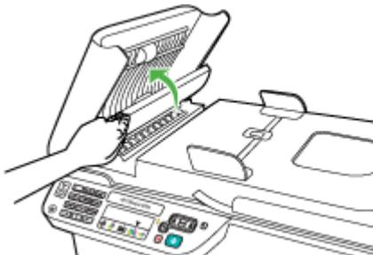
5. Reinigen Sie den Kunststoffstreifen mit einem mit mildem Glasreiniger befeuchteten weichen Tuch oder Schwamm.
