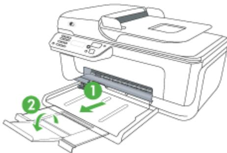
2. Legen Sie die Druckmedien mit der zu bedruckenden Seite nach unten entlang der rechten Seite des Hauptfaches ein. Achten Sie darauf, dass der Medienstapel
