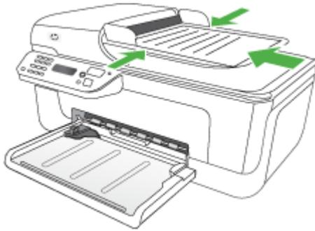
2. Deslice las guías de anchura hacia adentro hasta que se detengan en los bordes izquierdo y derecho del sustrato.
