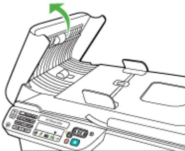
4. Levante el mecanismo del alimentador automático de documentos.
