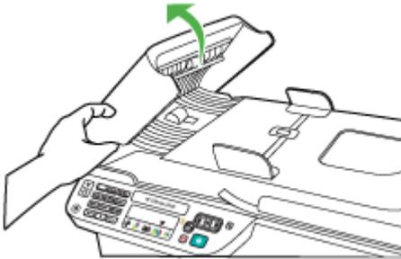
3. Continúe levantando la cubierta del alimentador automático de documentos hasta la posición vertical.
