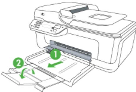
2. Inserte el soporte con la cara de impresión hacia abajo a lo largo del lado derecho de la bandeja principal. Asegúrese de que la pila del sustrato se alinee con los bordes del lado derecho y posterior de la bandeja y que no exceda la marca de línea de la bandeja.
