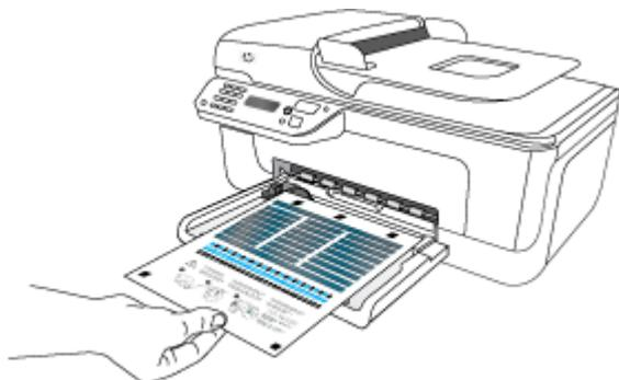
4. Coloque la página de alineación boca abajo sobre el cristal del escáner. Para obtener más información, consulte [Carga de un original en el cristal del escáner](#).
