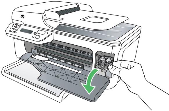
3. Espere hasta que el carro de impresión esté inactivo y en silencio y, a continuación, presione ligeramente el cartucho de tinta hacia abajo para liberarlo.
