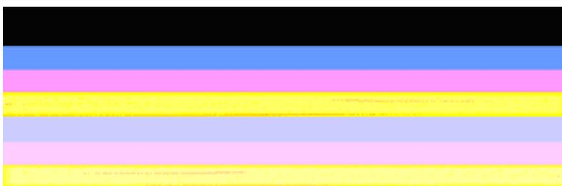
Esempio di barre di colore errate: La barra gialla presenta **striature** di un altro colore.
