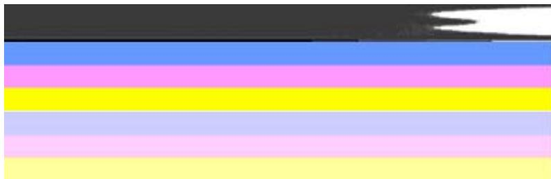
Esempio di barre di colore errate: La barra superiore presenta **striature irregolari o sbiadite**.
