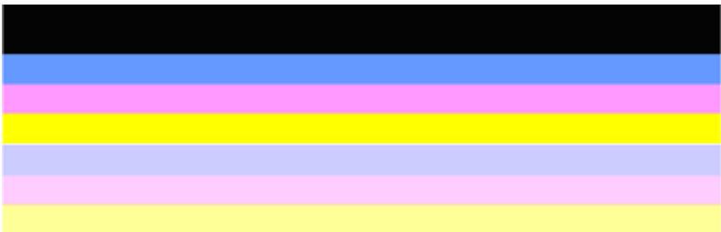
良好颜色条的示例：所有颜色条是纯色的，边缘清晰，并且在整个页面中的颜色是均一的。打印机工作正常。
