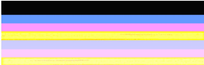
较差颜色条的示例：黄色条带有其他颜色条纹。
