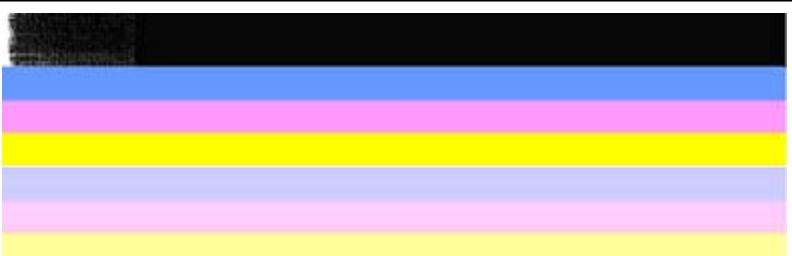
较差颜色条的示例：顶部颜色条**一端带有锯齿**。
