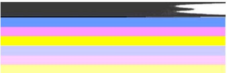
较差颜色条的示例：顶部颜色条有**不规则条纹或者褪色**。
