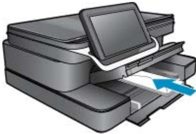
e. Deslice la pila de sobres hasta que se detenga.
