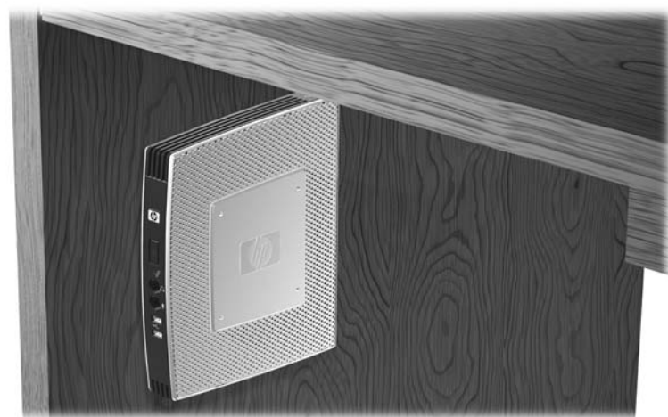
图 C-8 安装在桌子下面的瘦客户机
