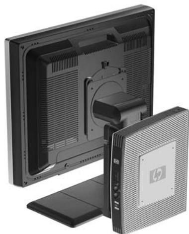
图 C-6 安装在监视器底座背面的瘦客户机
