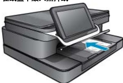
3. 滑动纸张宽度导轨，直到其紧靠纸张边缘。
