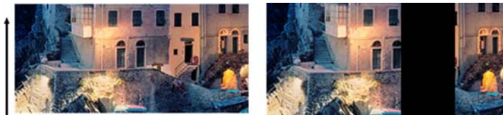
Σάρωση πρωτοτύπου με βλάβη μονάδας CIS
