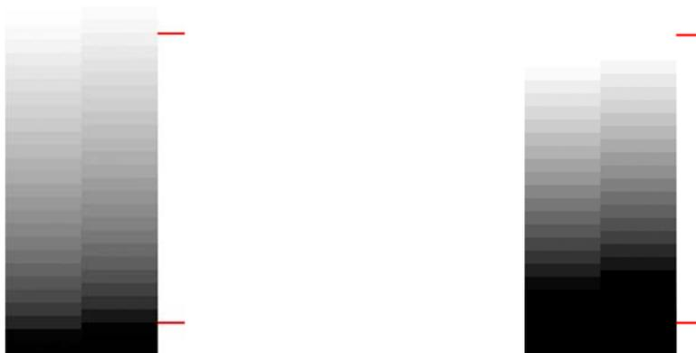
Si su patrón escaneado se parece al patrón incorrecto de la derecha, donde aparecen recortes en zonas oscuras o claras, póngase en contacto con el servicio de asistencia técnica de HP y notifíqueles que existen “recortes en zonas oscuras/claras”.
