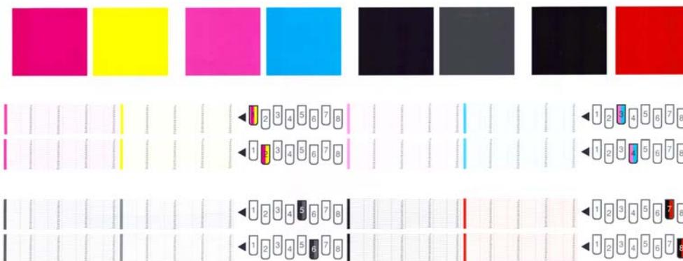
Commencez par regarder la partie supérieure de l'impression (partie 1). Chaque rectangle doit avoir une couleur uniforme et ne doit être parcouru par aucune ligne horizontale.
