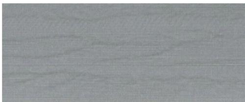
Cet aspect est caractérisé par des bandes ondulées et horizontales produites par des erreurs de positionnement de points induites par air (DPE). Dans des cas extrêmes, cette anomalie prend l'aspect d'un grain de bois. Le problème se produit le plus fréquemment sur les tâches d'impression réglées pour une faible qualité et une haute vitesse. Il ne se produit pas lorsque le réglage de qualité d'impression personnalisé est réglé sur « Optimale ».
