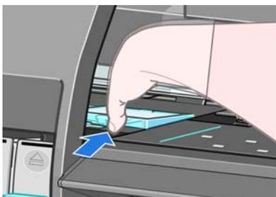
4. Poussez sur le bord à onglet jusqu'à ce que l'absorbeur s'enclenche. Vérifiez que le haut de l'absorbeur d'encre est installé bien à plat et qu'aucun des coins n'est plus haut que le plan de la platine.
