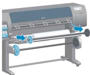
La bobine comporte un moyeu à chaque extrémité permettant de maintenir le rouleau en place. Retirez le moyeu bleu à l'extrémité gauche pour monter un nouveau rouleau. Le moyeu glisse le long de la bobine pour monter des rouleaux de différentes largeurs.
