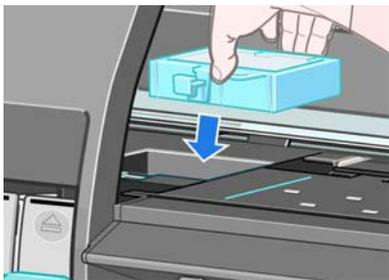
2. Insérez le bord arrière de l'absorbeur dans l'embout sur le crachoir.
