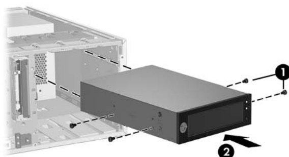
図 16 DX115 ケースの HP Z210 CMT（横置き）への取り付け
