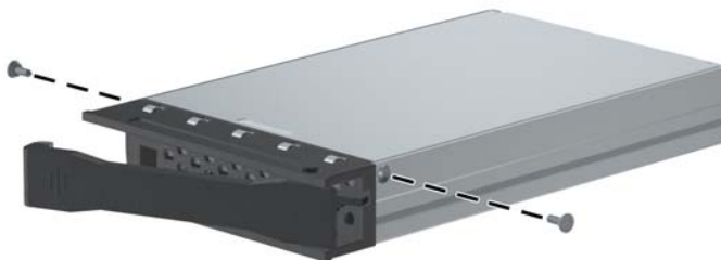
図 28 固定用ネジの取り付けなおし
