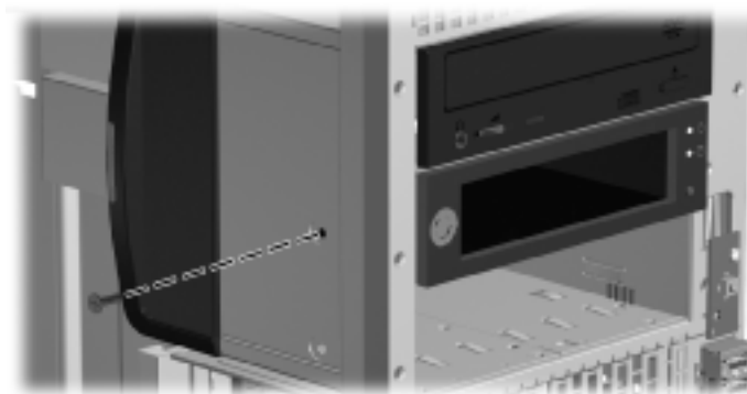
図 21 搬送用サポートネジの取り付け
