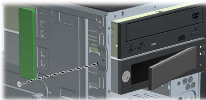
図 19 搬送用サポート ネジの取り付け
