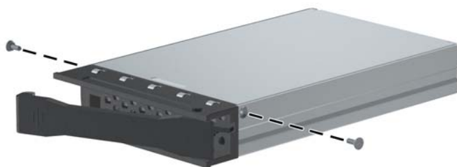
図 24 固定用ネジの取り外し
