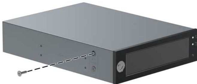
図 8 搬送用ネジの取り外し
