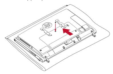
3 Sejajarkan kedua tab (A, B) pada braket atas VESA dengan dua lubang (C, D) pada dudukan braket VESA. Kencangkan braket atas VESA ke dudukan braket VESA dengan menggunakan keempat sekrup ukuran 8-mm yang disediakan.
