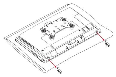
3 Pasang penutup lubang kaki sehingga menutupi lubang-lubang yang timbul setelah kaki komputer dilepas. Pasang kedua sekrup ukuran 8-mm yang sudah disediakan.
