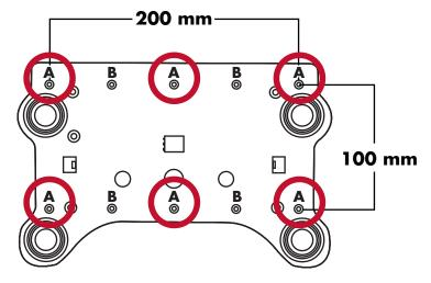
Dirancang untuk layar datar dengan ukuran diagonal dari 584 mm hingga 786 mm, dan berat maksimal 22,7 kg
