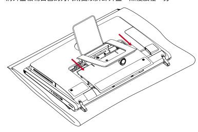
6 使用六角螺絲起子(建議使用尖端帶有磁性的螺絲起子),拆卸電腦支架上的四個螺絲。
