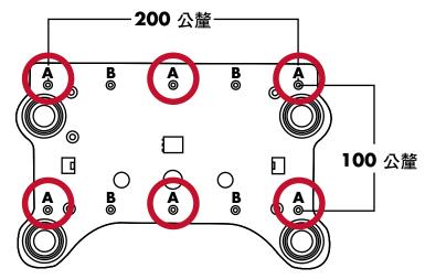
■ 專為對角線尺寸從 584 公釐 (23 英吋)至 786 公釐 (30.9 英吋),且最大重量為 22.7 公斤 (50 磅)的平面顯示器所設計
