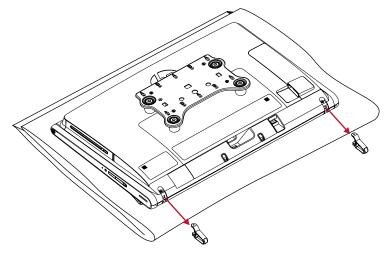
3 安裝支架鑲嵌物,填滿移除支架後所留下的空隙。插入兩顆內附的8公釐(0.3英时)螺絲。
