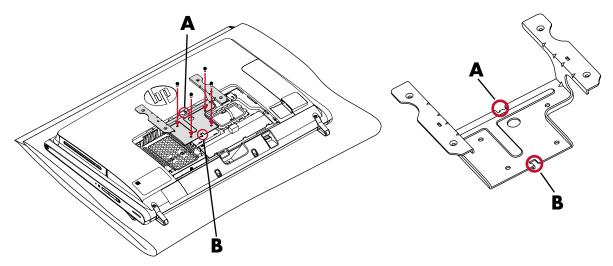
2 將外蓋插槽滑進 VESA 底座以重新固定外蓋板,並且重新插入外蓋板螺絲。
