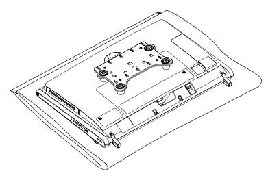
請依照壁掛設備製造商的指示將電腦掛至牆壁上。如需壁掛設備的規格,請參閱第2頁的〈所需項目〉。
