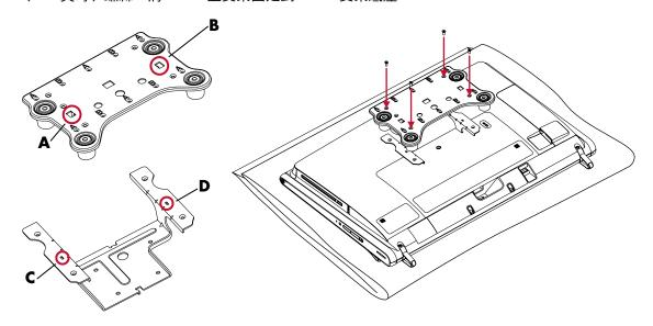
現在您已經完成 VESA 配接組件的安裝,隨後您就可將電腦固定至壁掛設備 (另行販售)。如果您希望移除電腦支 架後再將電腦掛至牆壁上,請參閱第8頁的〈拆卸腳架(選用步驟)〉。
