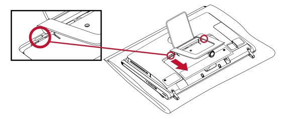
**5** 將外蓋板朝自己的方向滑動以拆卸外蓋,然後放在一旁。
