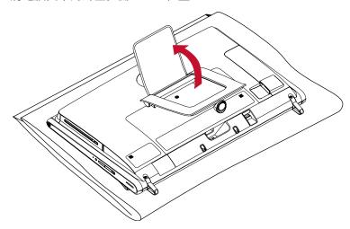
3 拆卸將外蓋板固定在電腦背部的螺絲。
