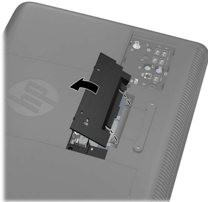
Figura 2-31 Reinstalación del panel de acceso central
