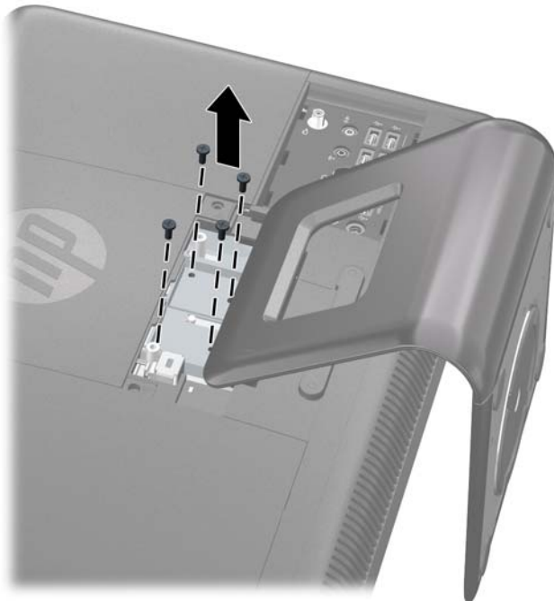
Figura 2-28 Extracción de los tornillos de la base
