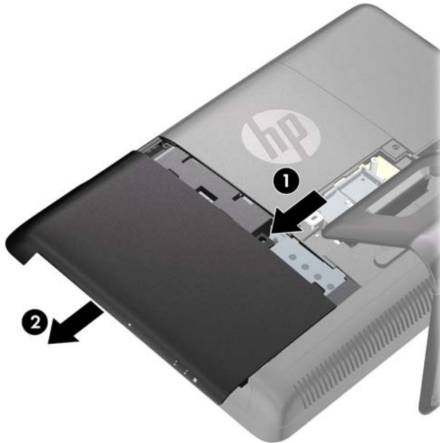
Figura 2-7 Extracción del panel de acceso a unidad
