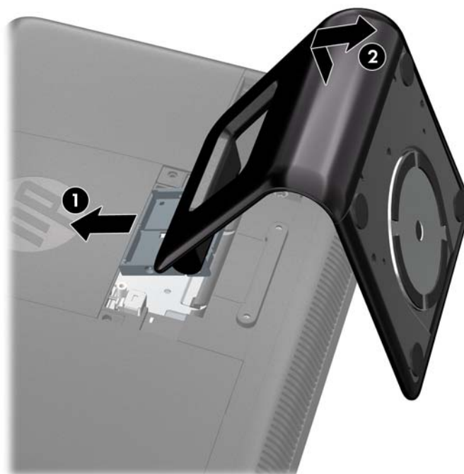
Figura 2-29 Remoção da Base
