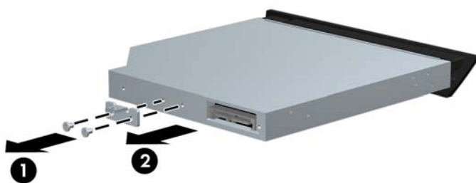
Figura 2-15 Remoção do Suporte de Segurança da Unidade Óptica
