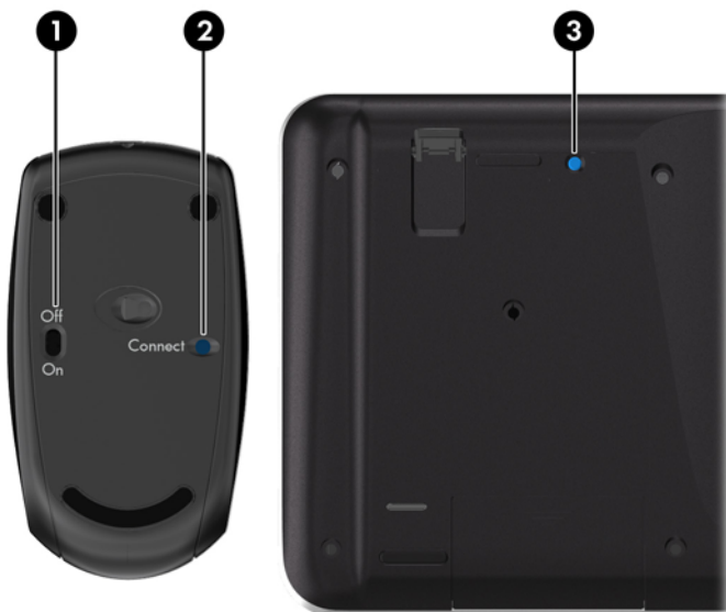
Figura 2-34 Sincronização do Teclado e Mouse sem Fio
