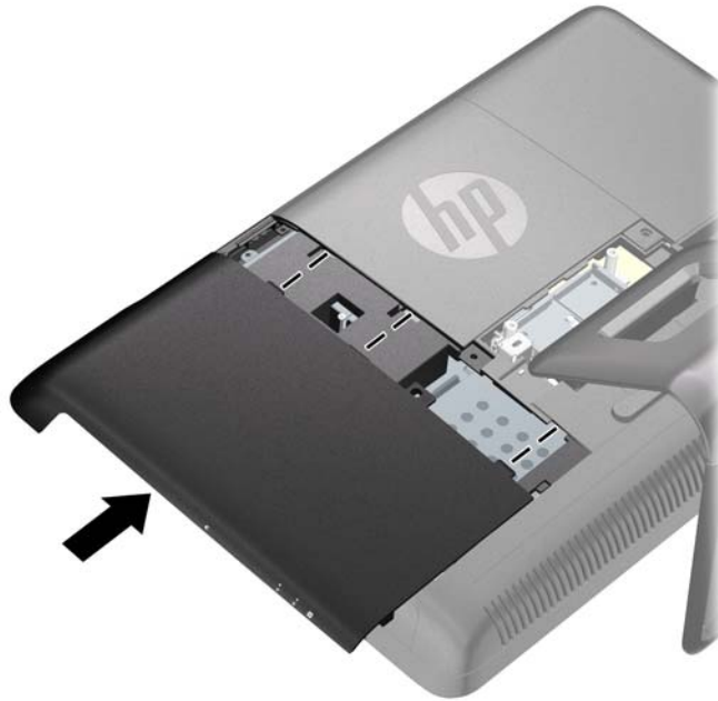
Figura 2-8 Reinstalação do Painel de Acesso à Unidade
