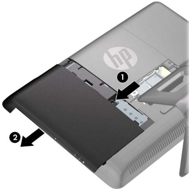
Figura 2-7 Remoção do Painel de Acesso à Unidade
