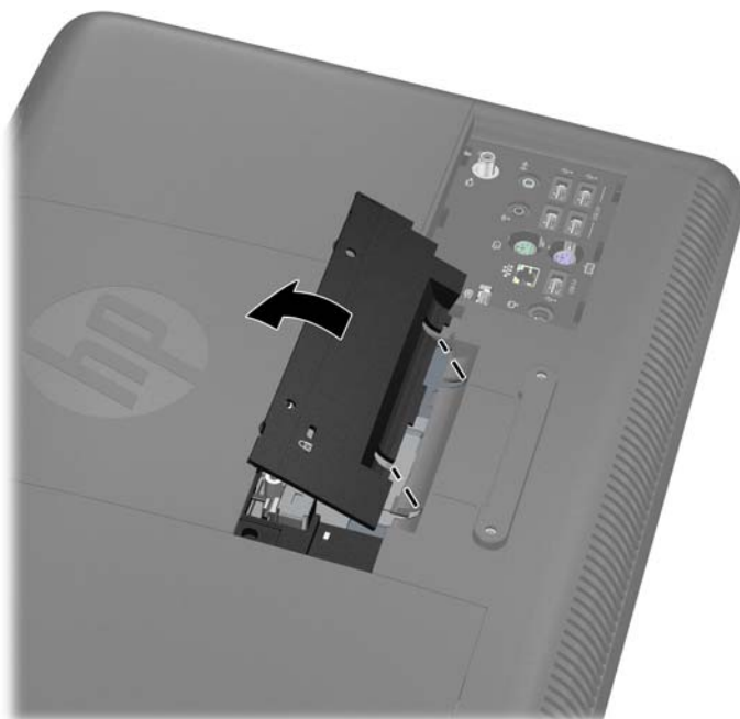
Figura 2-31 Reinstalação do Painel de Acesso Central
