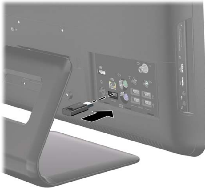
Figura 2-33 Instalação do Receptor sem Fio
