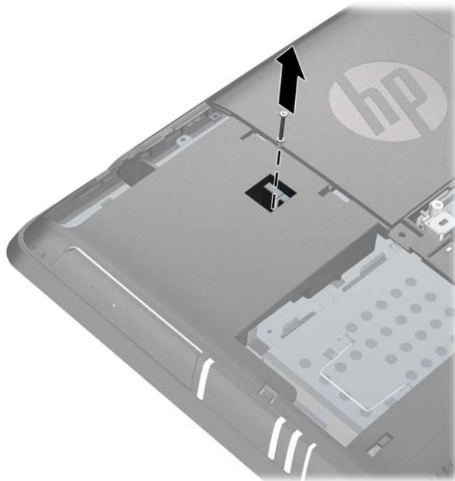
Figura 2-13 Remoção do Parafuso de Segurança da Unidade Óptica
