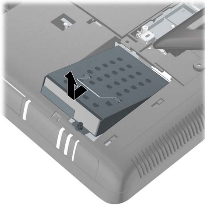
Figura 2-20 Remoção do Compartimento da Unidade de Disco Rígido
