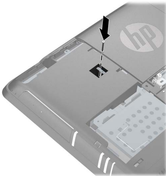
Figura 2-18 Instalação do Parafuso de Segurança da Unidade Óptica
