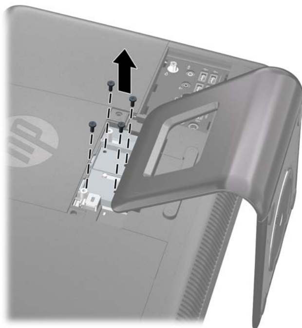
Figura 2-28 Remoção dos Parafusos da Base
