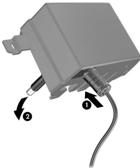
Figura 2-3 Inserção do Cabo da Fonte de Alimentação através do Orifício da Tampa da Porta
