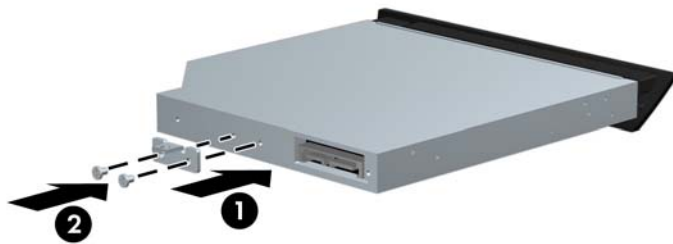
Figura 2-16 Instalação do Suporte de Segurança da Unidade Óptica
