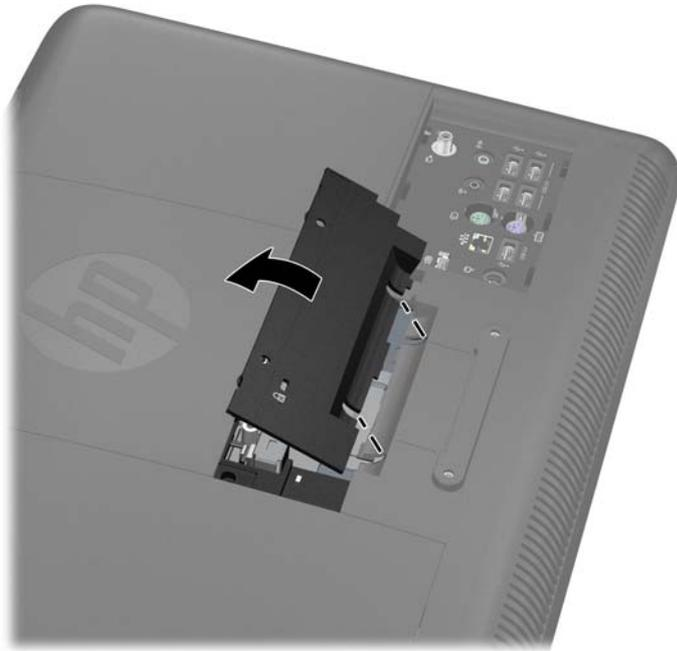
13. 若要將電腦連接到螢幕支臂上，請用 4 個 10 公釐長的螺絲穿過螢幕支臂板上的插孔並插入電腦上的 VESA 安裝孔。
