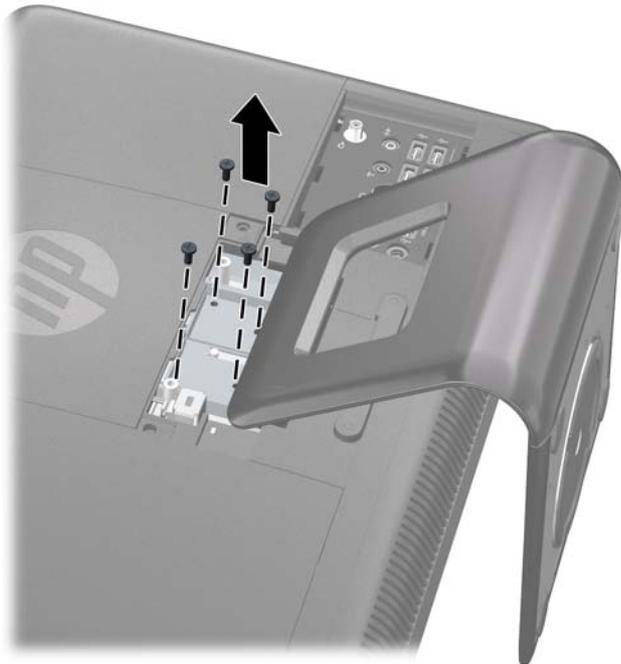
10. 將支架往標誌的位置推 2.5 公分 (1)，再將支架底座向上傾斜然後往回拉（往標誌的相反方向）(2)，即可將支架從電腦取下。
