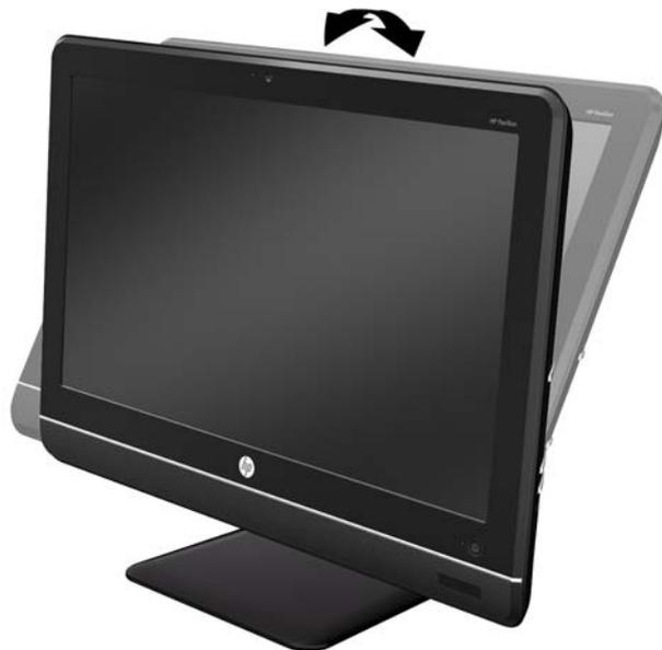
電腦的底座下方有旋轉輪，讓您左右旋轉電腦來取得最佳觀看角度。
