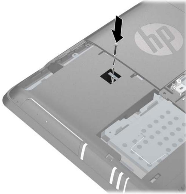
5. 裝回磁碟機維修面板（請參閱[位於第 16 頁的裝回磁碟機維修面板](#)）。
