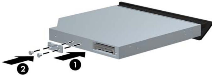
3. 將光碟機推入磁碟機托槽的底部。
