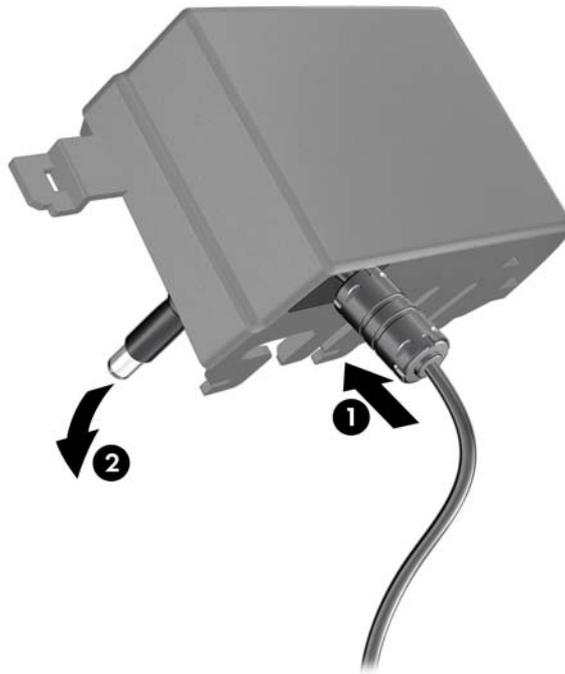
4. 將電源線連接到電腦後方的電源接頭 (1)，把第二條電源線連接到磚狀電源供應器 (2)。
