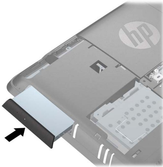
4. 安裝光碟機後方旁的安全螺絲，固定光碟機。
