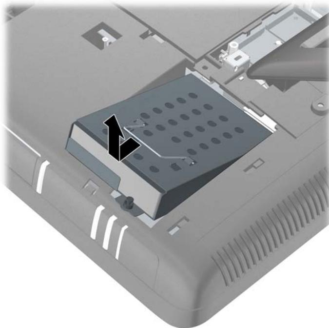
10. 若要從硬碟機盒拆下硬碟機，請先拆下將硬碟機固定於硬碟機盒上的四顆螺絲 (1)，再把硬碟機從硬碟機盒中推出 (2)。
