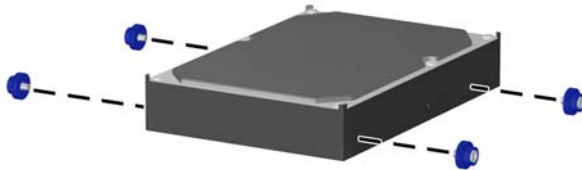
Figura 2-38 Instalación de los tornillos guía en la unidad de disco duro
