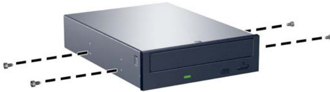
Figura 2-25 Instalación de tornillos guía en la unidad óptica
