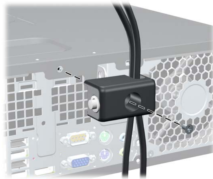
Figura C-5 Acoplado del bloqueo al chasis
